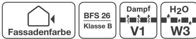
Stumpfmatt auftrocknende Silikonharz-Fassadenfarbe mit ausgeprägtem Abperleffekt für spannungsarme Anstriche von Fassadenflächen. Wetterbeständig.
